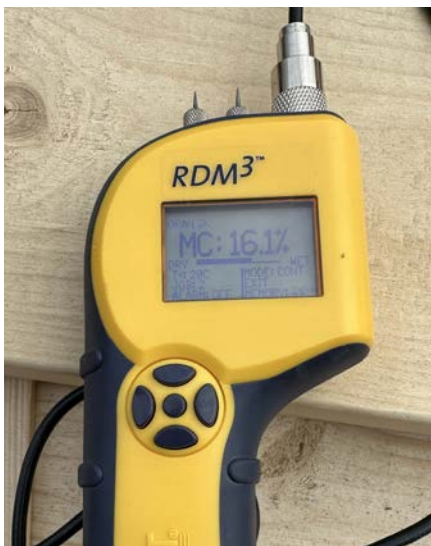
Dokumentera fuktkvot vid behov.
