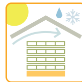
Impregnerat virke ska skyddas med toptäckning
