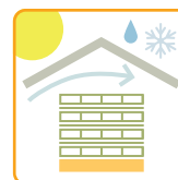
Impregnerat virke ska skyddas med topptäckning
