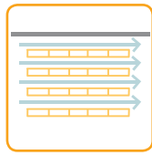
Strölägg limträet om det blivit fuktigt
